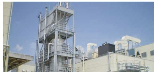
溶剤回収システム(株)クレハエンジニアリング製品
