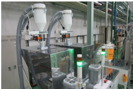
再生原料ブレンド装置
